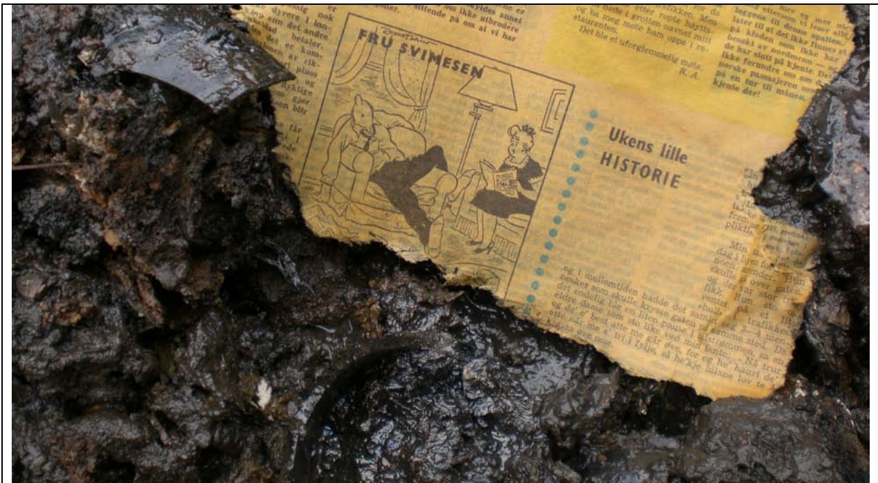
Foto 1-3. Sjakt 1. Det er mye organisk materiale i avfallet, og det er til dels lite omdannet. Avisen er fra 1959.
