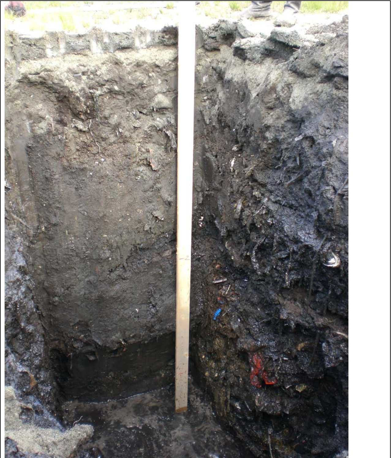
Foto 2-1. Sjakt 2. Svært våte avfallsmasser, men sjaktveggene står stabilt, og massene er gravbare.
