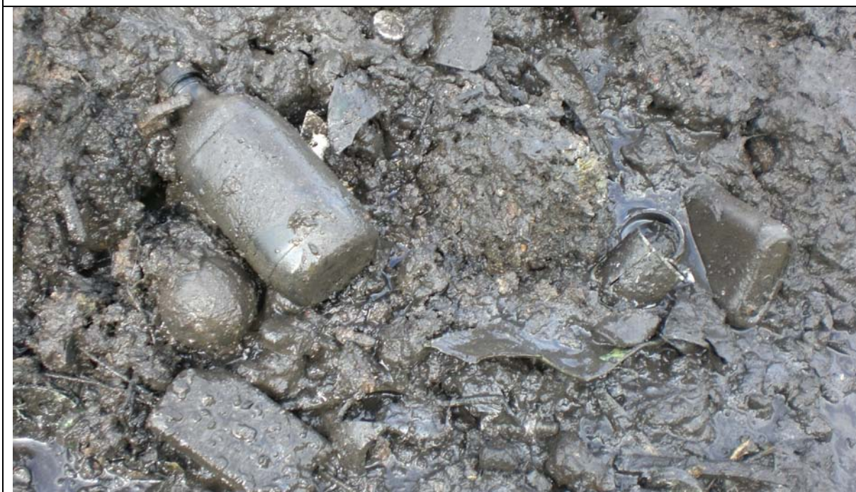
Foto 3-3. Sjakt 3. Det er mye organisk materiale i avfallet. Det meste av avfallet er en diffus "matrix", men det er mye flasker, lær (sko), plastremser mm.. Svært lite stein.
