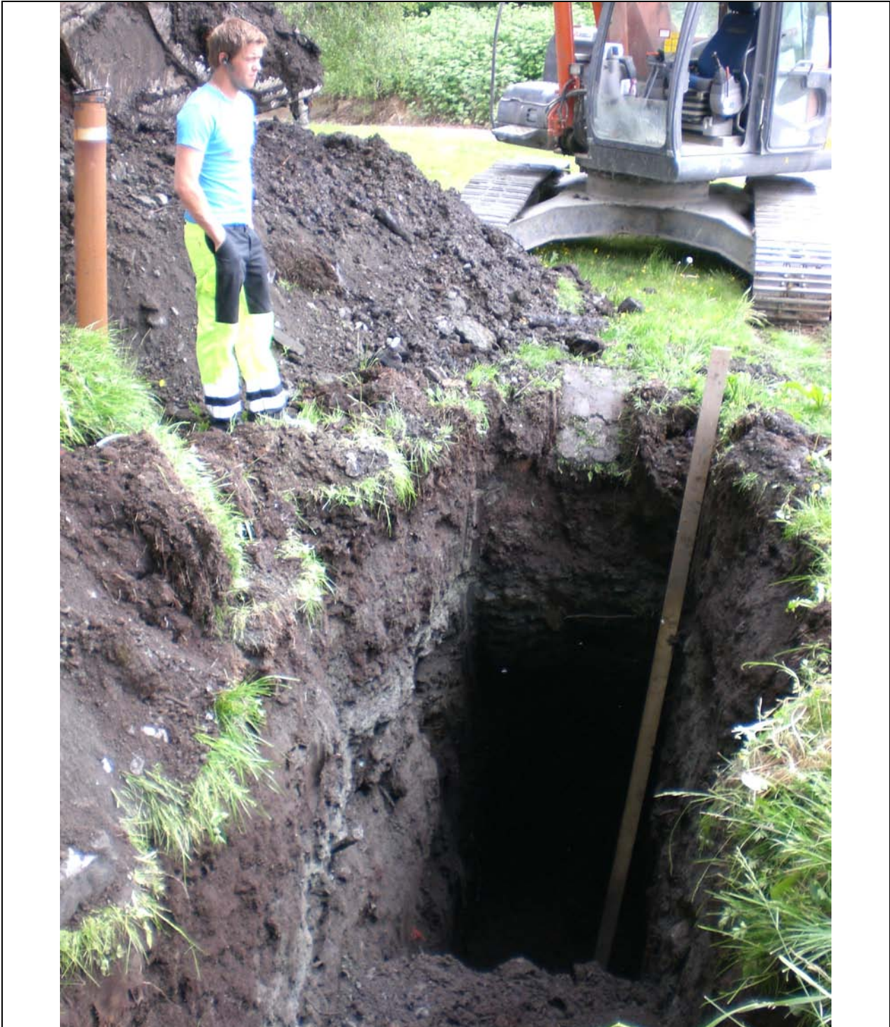
Foto 7-1. Sjakt 7. Blandet naturlig jord til ca 2.5 m under terreng. Derfra avfall til ca 5 meter. Relativt tørt avfall. Sjaktveggene er stabile, og massene er gravbare.
