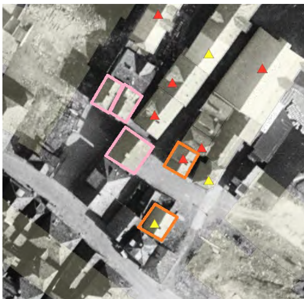
Figur 19 (t.v.) Omrissene markerer bevart, selvgrodd trehusbebyggelse på Sliberget (rosa) og Bekketomten (oransje). De tre førstnevnte bygningene er vedtaksfredete. Røde og gule trekanter representerer SEFRAK-registrerte bygg, datert henholdsvis før og etter 1850. Bakgrunnsbildet er flyfoto fra 1951
