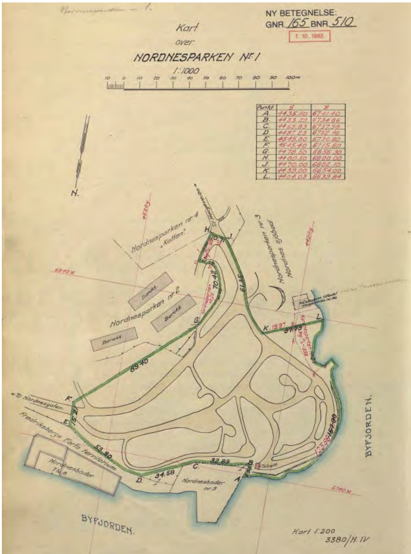
Figur 10: Målebrevkart slik det fremstår etter kartforretningen over «Nordnesparken Nr.1» som ble avholdt 6/11-1939. Kilde: Oppmålingsarkivet BBA/A-0983/Kka/L0048
