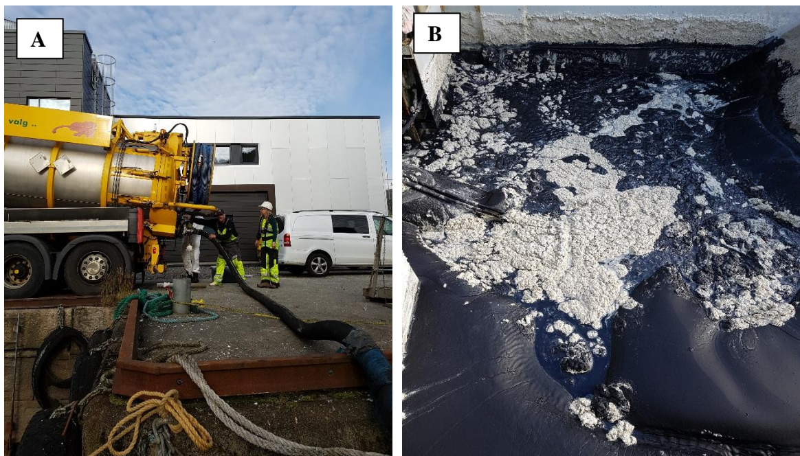
Figur 34 Bilder fra utlegging av blandingen av skjellsand og pulverisert kull. A) Tankbil med blanding av PAC, NaCl og saltvann. B) Lasterommet på fartøyet til Boston AS der kull-blanding ble blandet med skjellsand og pumpet ut gjennom ledning til testfeltet.
