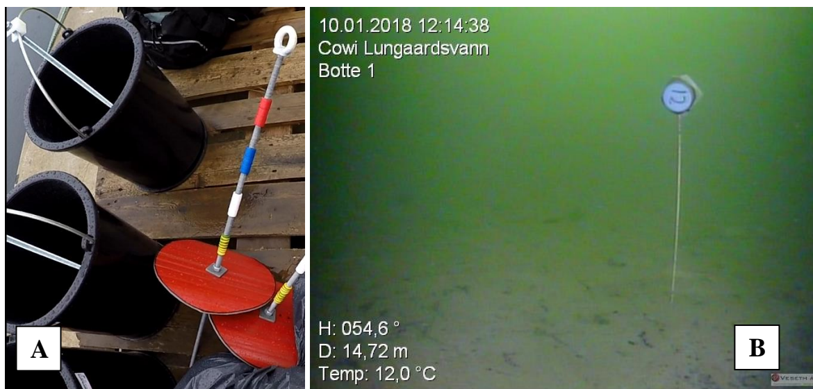
Figur 26 A) Bilde av målepinnene og de spesialtilpassede bøttene og målepinnene før utsetting i testfelt 1. Det ble i tillegg festet et tau på ca. 1 m og en liten blåse på bøttene/målepinnene. B) Bilde av den eneste målepinnen som ble gjenfunnet. Det er usikkert om målepinnen står oppreist eller har vellet siden det bare er tauet og blåsen som er synlig.
