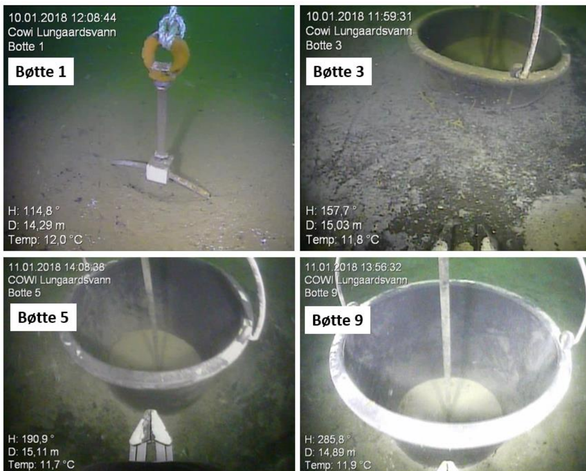
Figur 25 Bøtte 1, 3, 5 og 9 i testfelt 1. Bøtte 5 og 9 stod helt på grensen av testfeltet, mens bøtte 1 stod i delfelt 1A og bøtte 9 i delfelt 1B. Bøtte 2, 4 og 6 som stod i skrånningen i den nordlige delen av testfeltet var alle veltet og kunne ikke benyttes til å vurdere tykkelse på tildekkingslaget. Det ble valgt å ikke bruke tid/ressurser på å gjenfinne bøtte 7 som var plassert et stykke utenfor testfeltet.
