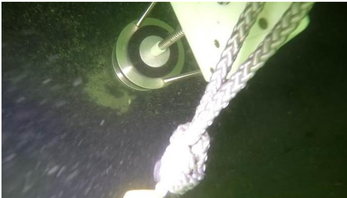
Figur 38 Bilde av laget med AquaGate+PAC 10% i delfelt 2B tatt med undervannskamera festet på kjerneprøvetaker før utlegging av de øverste lagene med skjellsand.
