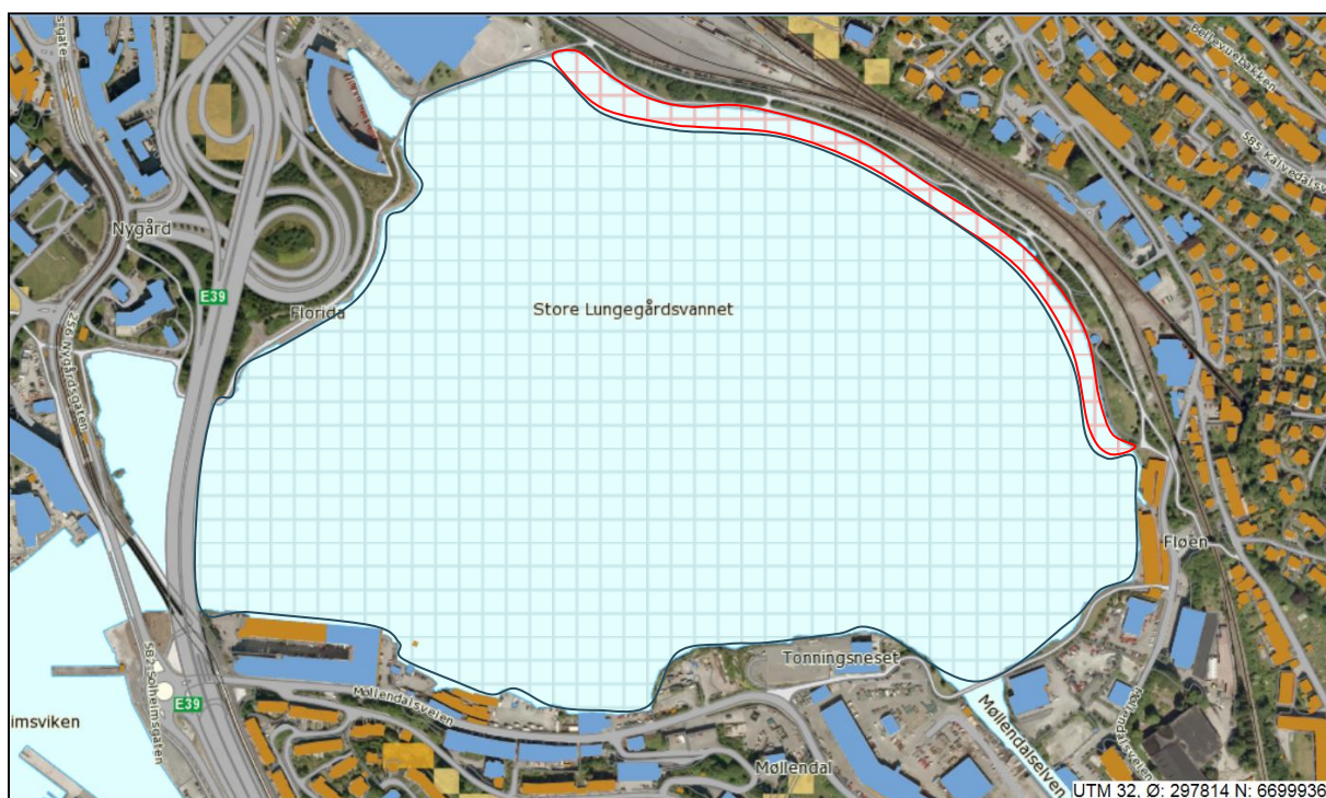
Fig. 10. Planlagte tiltak er: 1) utvidelse av parkarealet i øst i en bredde av ca 30 meter (rød skravor), samt 2) tildekking av det meste av bunnarealet i SL med 1 meter tunnelmasse (blå skravor). Kartkilde: Skog og Landskap 2014.
