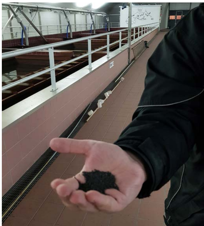
Vannrenseteknikken blir stadig bedre, her testes en ny filtertype, Filtralite®, på Svartediket. Blir resultatet som forventet sparer vi strøm, rent vann og kjemikalier ved rengjøring av filterne. (Foto, Einar Høgmo)
