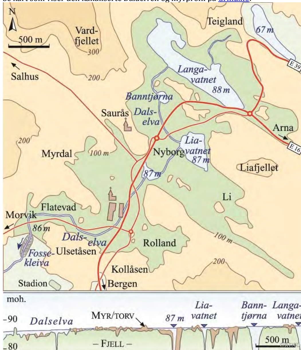
Figur 3: Kartstnittet viser Åsamyrene der Dalaelven ble kanalisert på slutten av 50-tallet. Nederst lengdeprofil over vassdraget og grunnen under.
