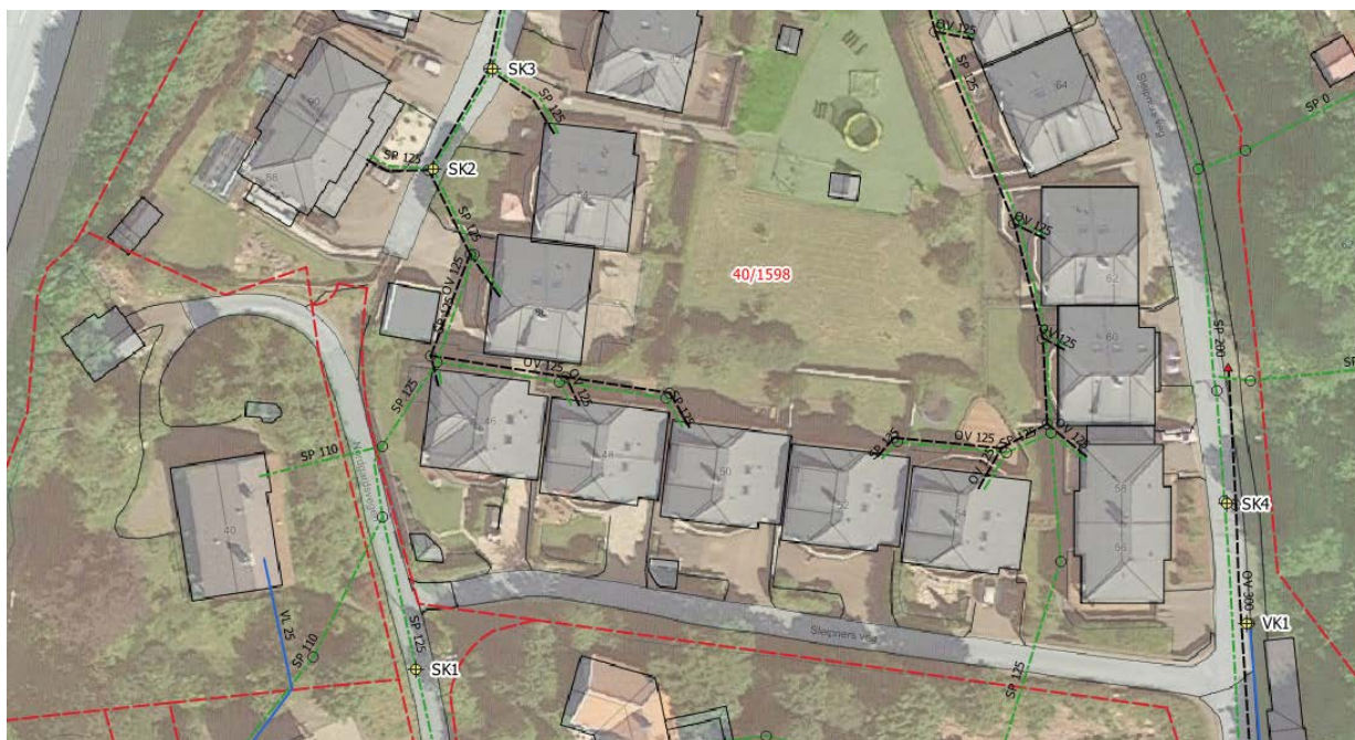
Bilde 1 Innmålte avløpskummer (SK1-SK4), innmålt vannkum (VK1)
