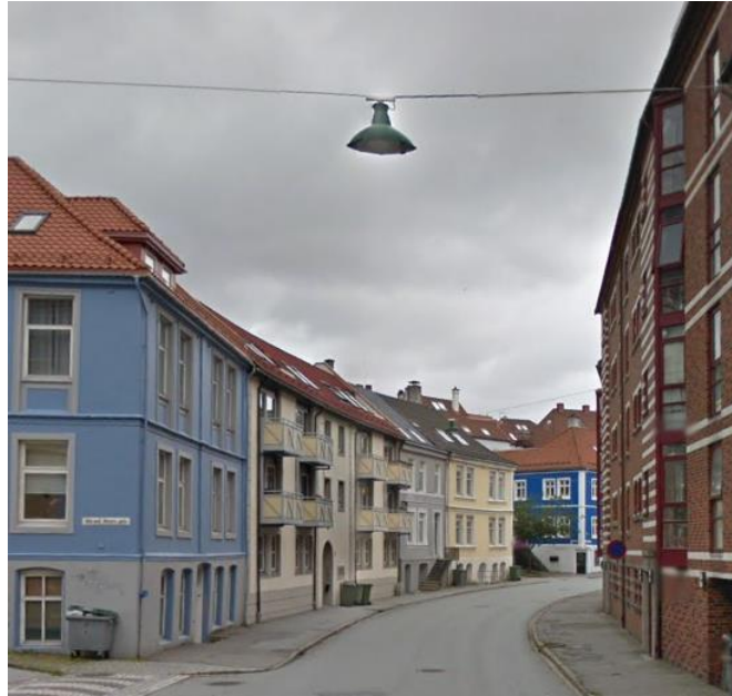
Figur 6-6: Typisk vaiermontert belysning i Sandviken, spent opp over gateløpet. Her fra Nye Sandviksveien. Foto: Google Street View.
