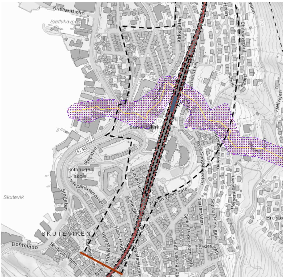
Figur 5.3-16 Aksomhetsområde flom (NVE) i sørlig del av planområdet i Sandviken, der traseen går i tunnel (BT5 Webkart)
