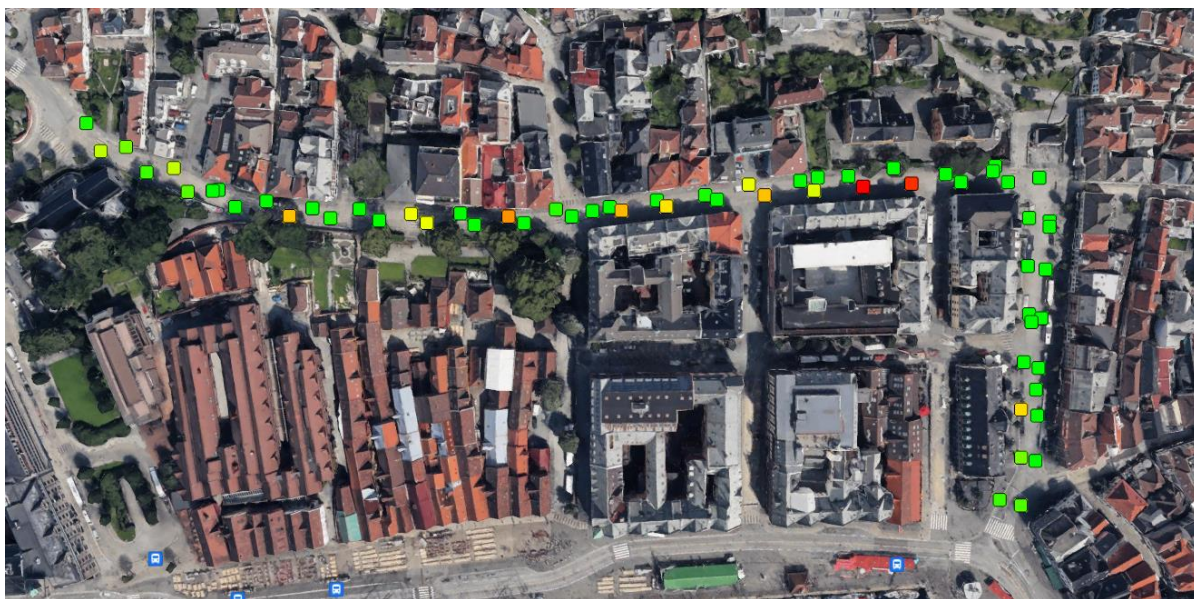
Figur 6 Bæreevne for strekningen med brustein i fargeskala. Røde prikker har bæreevne 8 tonn og grønne 14 tonn.
