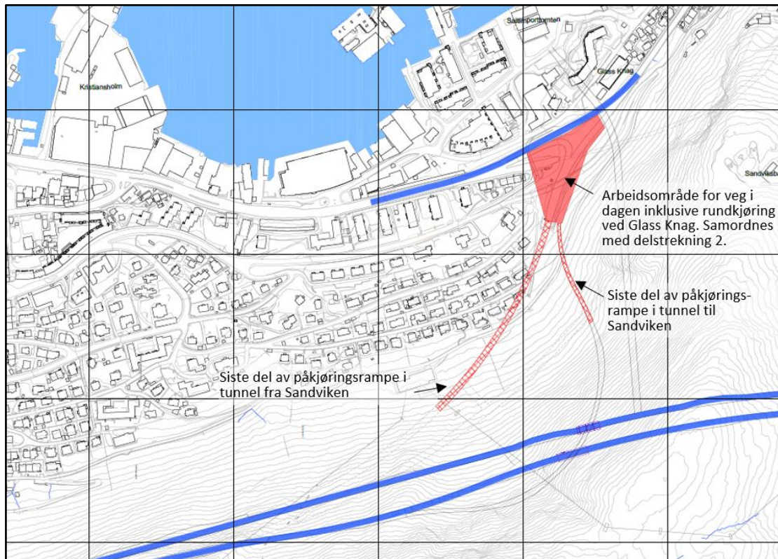
Figur 7-5. Anleggsfase for slutføring av rampene i Sandviken og bygging av veg i dagen ved Glass Knag som del av delområde 2.
