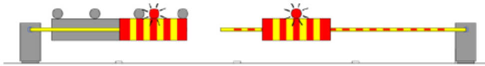
Figur 4.2.3-1 Eksempel på stengebom ved hovedtunnelen.
