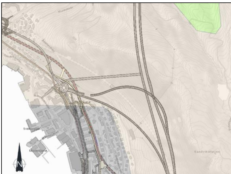
Figur 5-57: Utsnitt fra NGUs løsmassekart (1:50 000) på nett lagt over gjeldende veg- og banemodeller. Brun farge indikerer bart fjell. Mørk grå farge indikerer fyllmasser. Det må forventes noe fyllmasse i tettbygd strøk også innenfor det brune området. Lys grønn indikerer tynt morenedekke.
