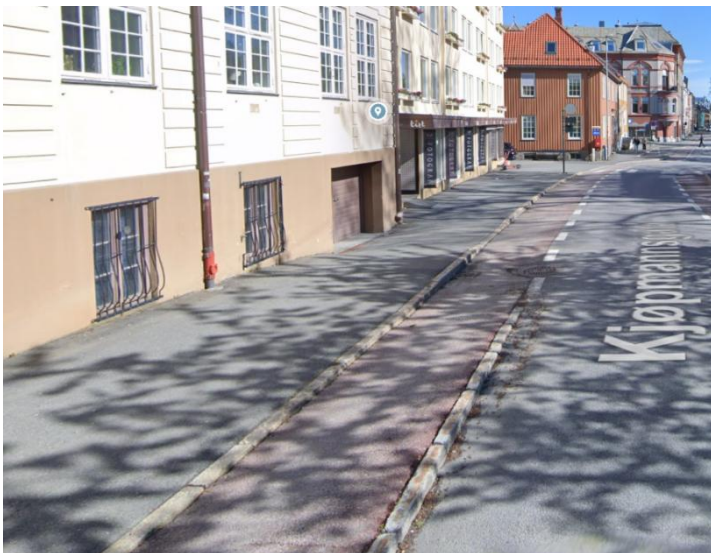
Figur 7 Bilde fra Kjøpmannsgata Trondheim med tilsvarende løsning. Viser også overgang til vanlig sykkelfelt. Bilde hentet fra Google
