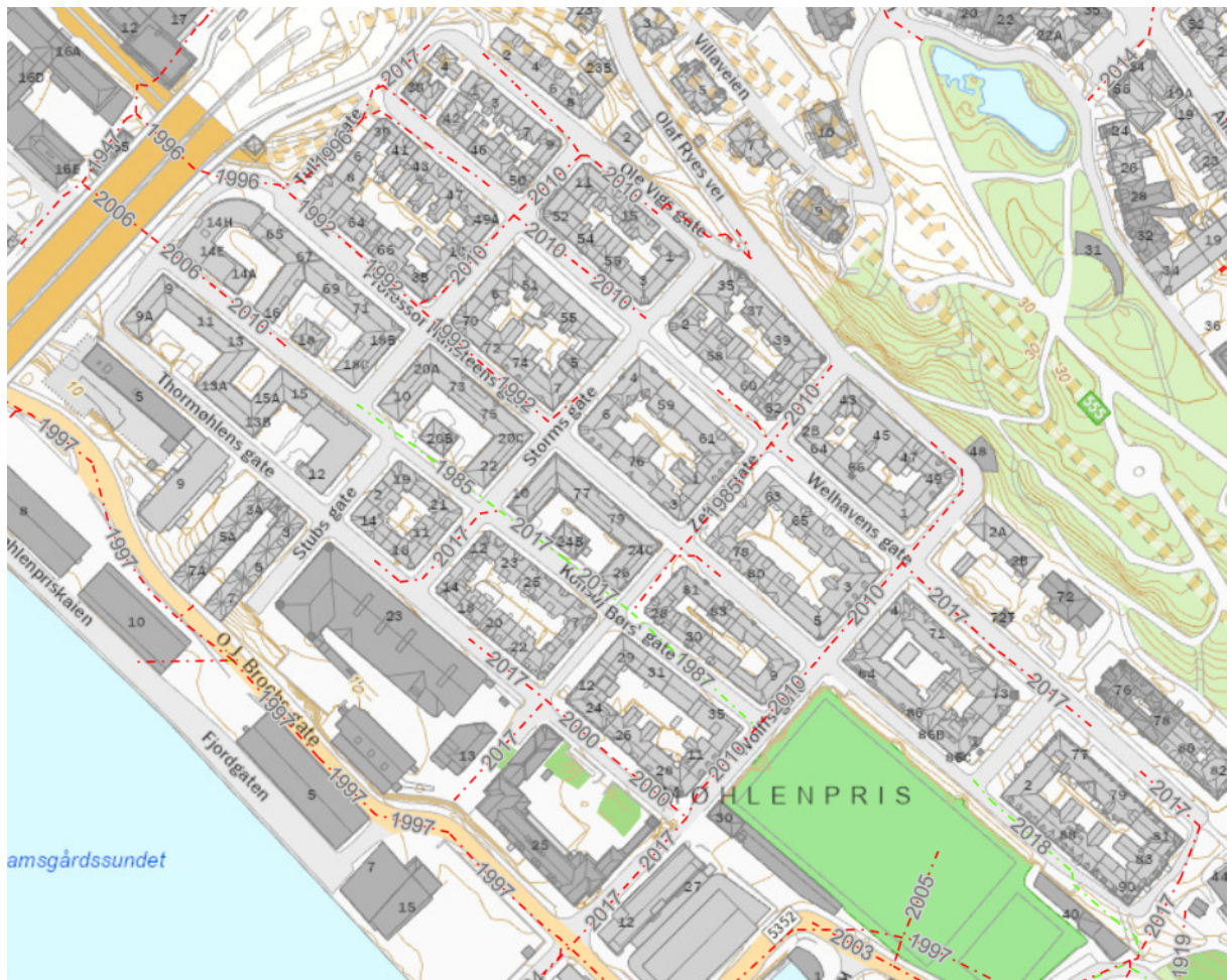
Figur 2.3.1 - Oversikt over avløpsledninger etter anleggsår
