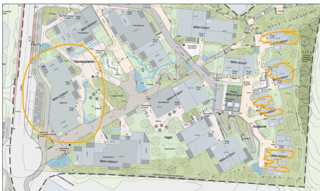
Figur 17: Oransje markering illustrerer blågrønt tak for fordrøyning i øvre del til venstre (avsett 380 m2 til blågrønt tak) og nedre del til høyre (avsett 400 m2 til blågrønt tak).
