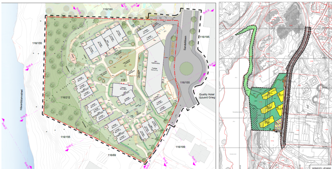
Figur 7 (venstre): Illustrasjonsplan av planforslaget med bebyggelse, uteoppholdsarealer, grøntområder og veier. Figur 8 (høyre): Plankart for tilgrensende reguleringsplan mot nord (arealplan-ID:65340000). Reguleringsplanen omfatter snarvei nordover til kollektivholdeplasser og oppgradering av veien Sandslivegen med fortau og sykkelfelt.
