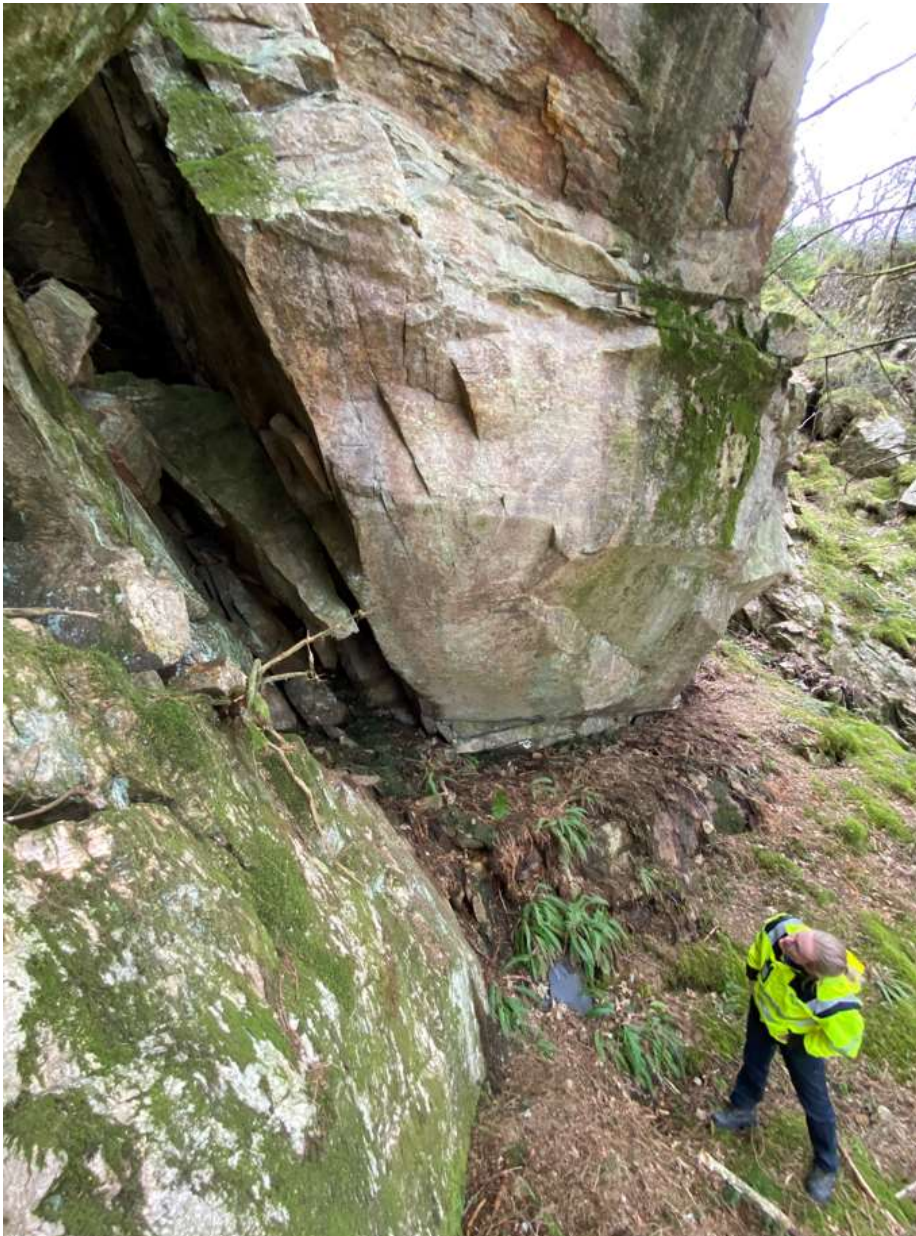
Figur 17: Nedside av en av de to større avløste partier. Foten av partiet hviler på en berghylle. Lokasjon 849 på registreringskart.
