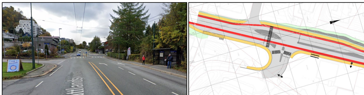
FIGUR 12: DAGENS KRYSS MED NATTLANDSFJELLET, OG SKISSE AV LØYSING MED MIDTSTILT SYKKELFELT GJENNOM KRYSS. FOTO: GOOGLE MAPS. SKISSE: NORCONSULT AS.
