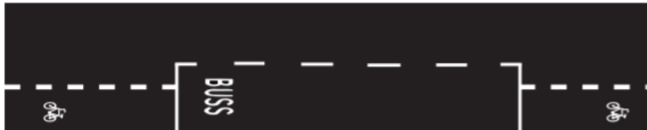
Figur 8.10 Oppmerking av sykkelfelt ved busslomme og kantstopp for buss
