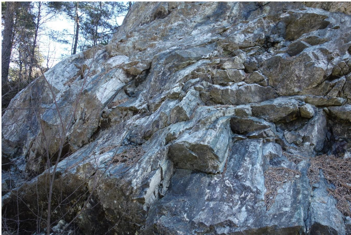
Figur 6. Bergmasse langs skjæringen helt vest på tomten, sett mot øst. Sprekkesystemene bærer preg av folding langs foliasjon.
