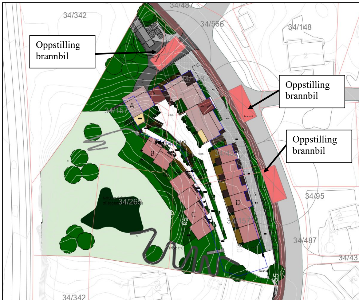
Figur 17. Oppstilling for brannbil
