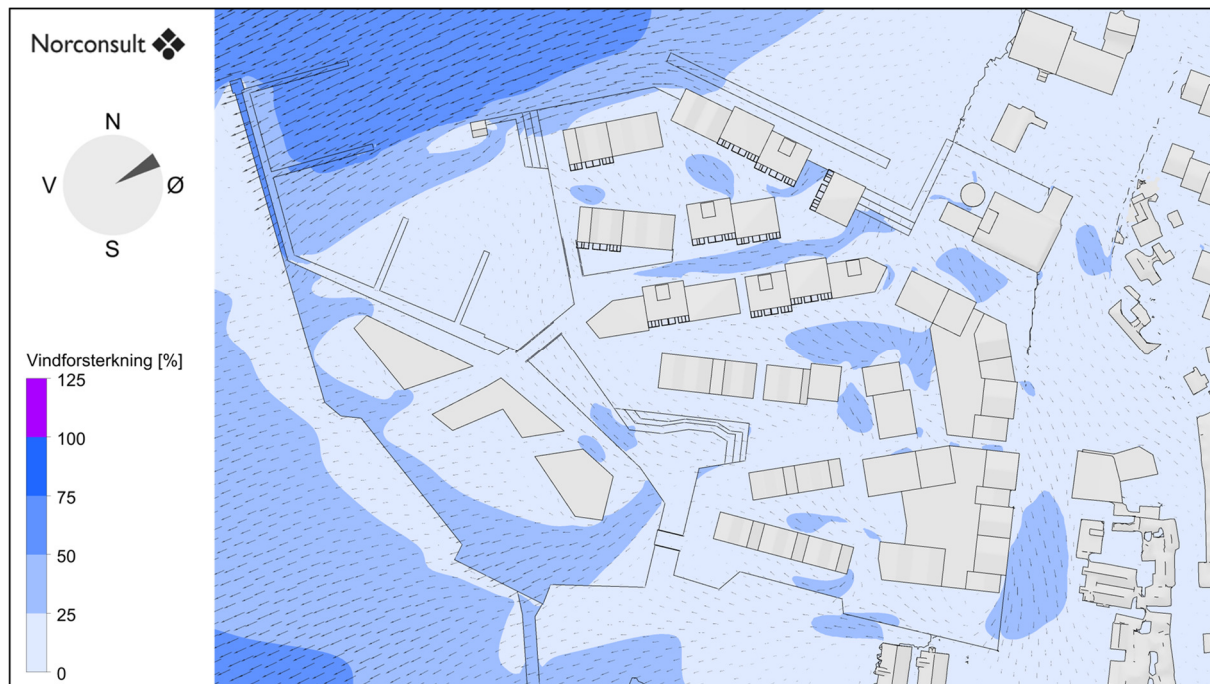
Figur 18: Vindforsterkning og strømningspiler ved vind fra 60°.
