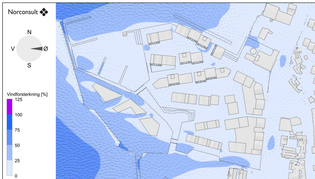
Figur 19: Vindforsterkning og strømningspiler ved vind fra 90°.
