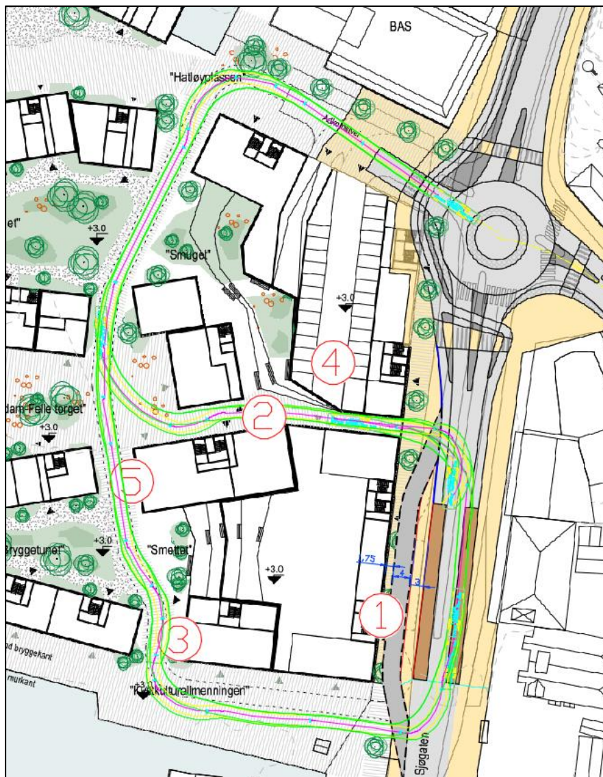
Figur 10-2 Alternative lokaliseringer for varelevering nummerert 1-5. Springer for lastebil (12m) i grønn linje, viser inn fra nord i rundkjøringen, og ut i Sjøgaten via Kystkulturellmenningen. Kantstopp for buss er vist med brune felter i Sjøgaten. Se vurderinger under.
