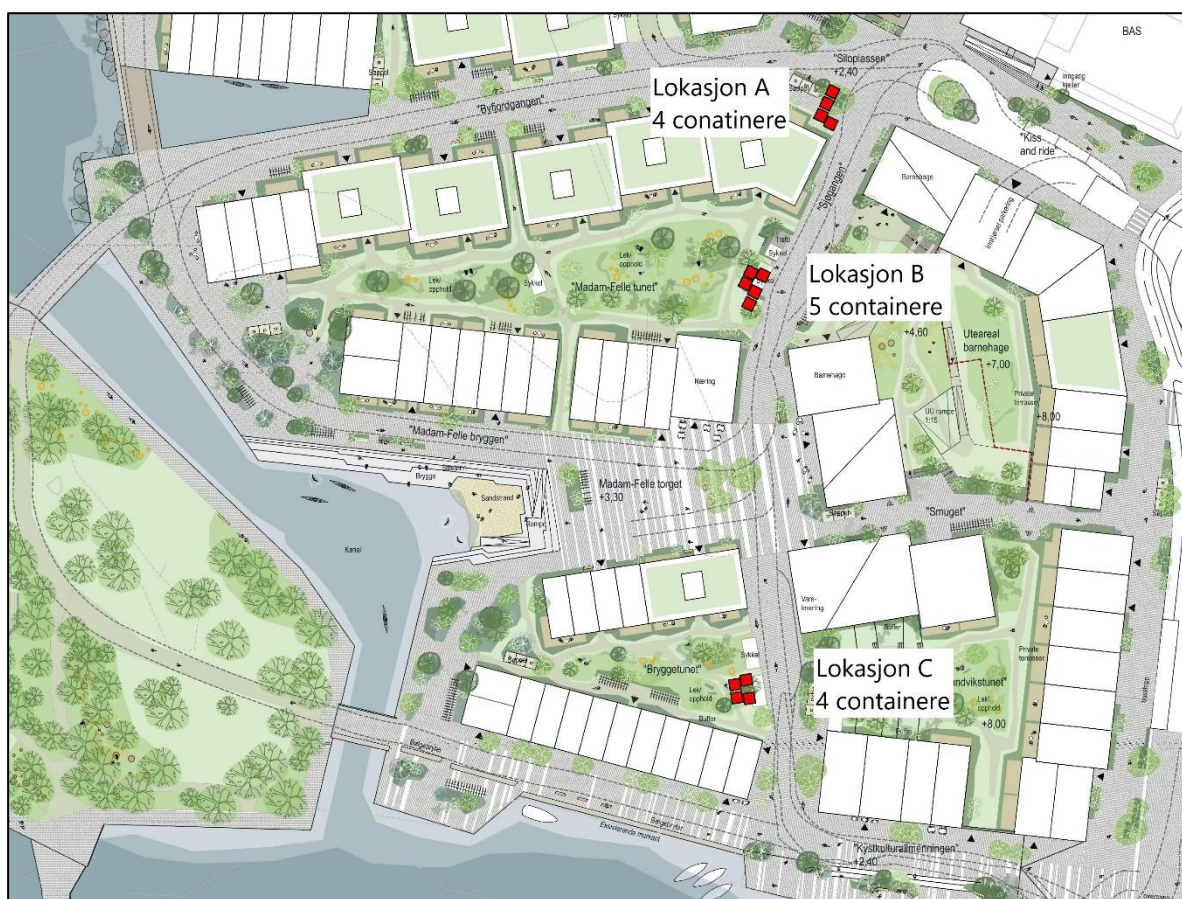
Figur 14 Oversikt nedgravde containere med kompresjon, totalt 13 stk.
