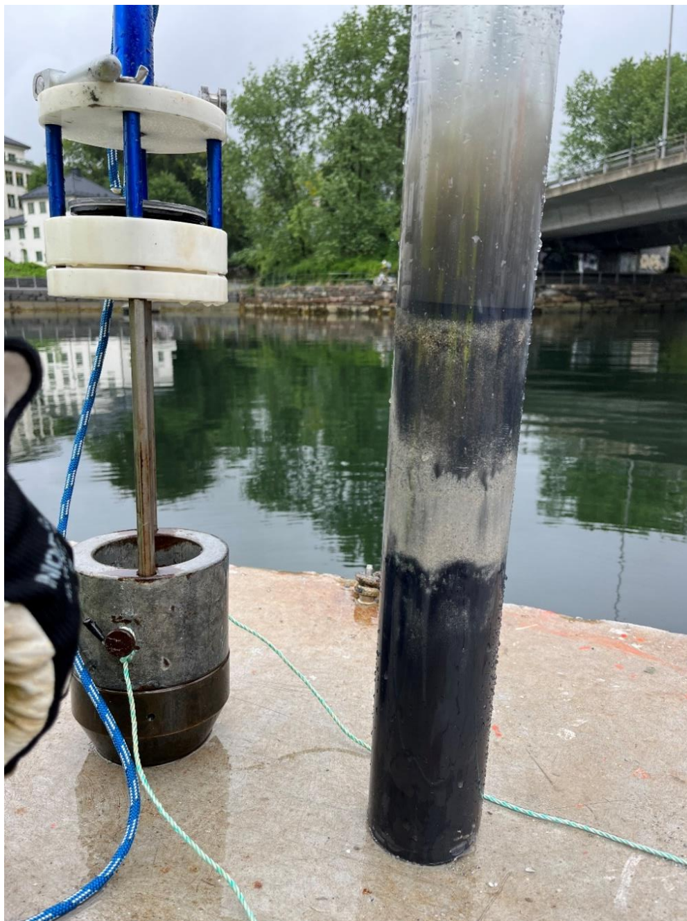
Figur 6 Det ble tatt kjerneprøver av sedimentet med en Uwitec kjernetaker med 90 mm rør. Bildet viser prøvetakeren til venstre og en sedimentkjerne til høyre.
