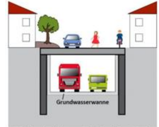
3. Verkehrsberuhigung an der Oberfläche, Durchgangsverkehr im Untergrund
