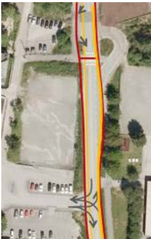
8. Busslomme ved Kjøkkelvikskole og avkjørsel til/fra parkeringsplasser og boliger: Konfliktpunkter Sykkel/Bil 4, Sykkel/Gående 4, Sykkel/Buss 2.
