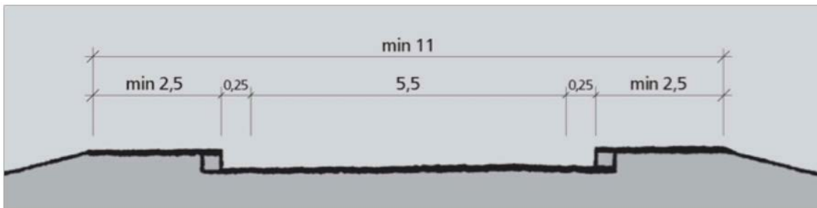
Figur 18. Normalprofil for Sa2 med tosidig fortau.
