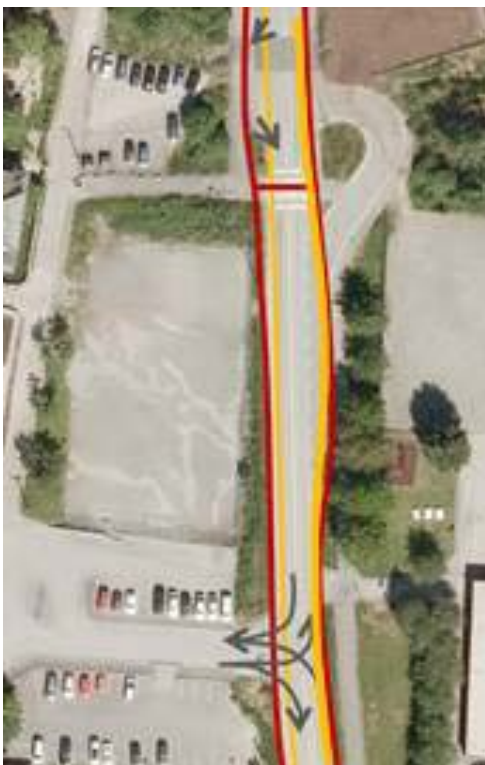
8. Busslomme ved Køkkelvikskole og avkjørsel til/fra parkeringsplasser og boliger: Konfliktpunkter Sykkel/Bil 4, Sykkel/Gående 4, Sykkel/Buss 2.
