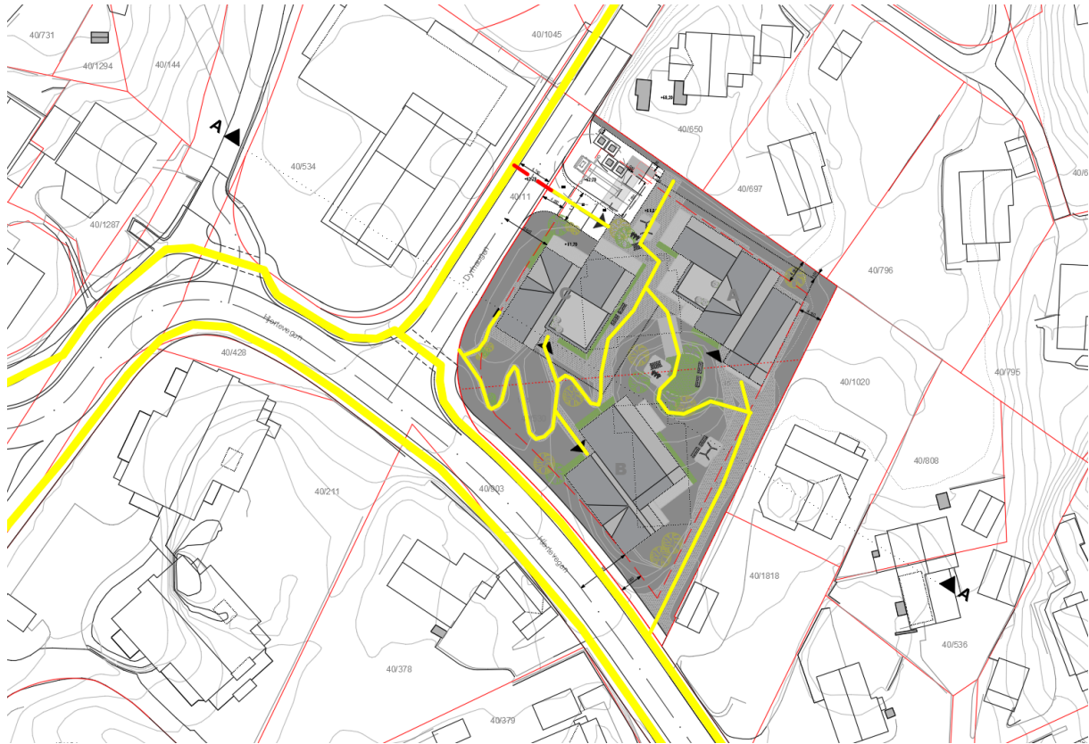
Figur 18: Trafikksikkerhetsanalyse: ferdselsårer er synliggjort med gule linjer og områder der sporingskurver krysser ferdselsårer er synliggjort med stiplet rød linje.
