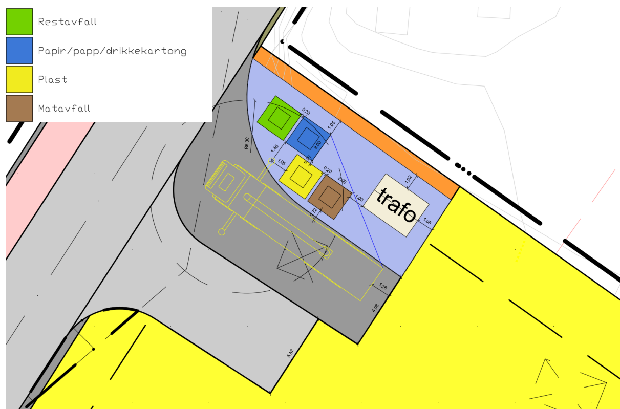
Figur 8: Plassering av de ulike nedgravde bunntømte containerne.
