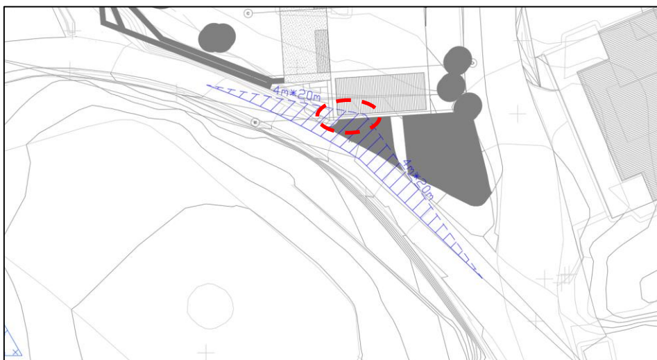
Figur 16: Siktkrav for avkjørselen fra ny blokkbebyggelse
