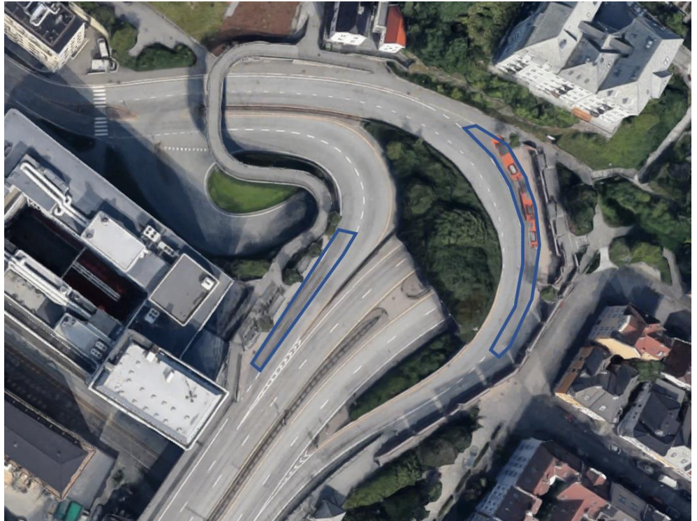
Figur 25 Holdepladserne ved Møhlenpris er blandt Bergens mest benyttede. Place- ringen i kurver på rampeanlæg gjør det yderst vanskelig at forøge kapasiteten.
