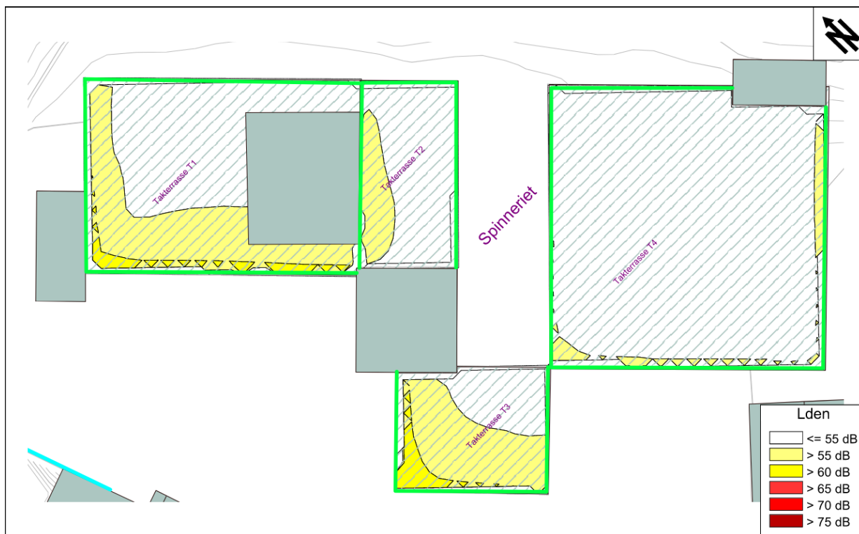
Figur 11. Takterrasser på Spinneriet. Støynivå i 1,5 m beregningshøyde med skjermende rekkverk i høyde 1,2 m over gulv (GRØNNE streker).
