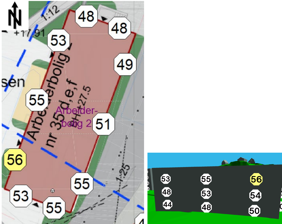
Figur 20. Arbeiderbolig 2. Høyeste støynivå, L_{den} (dB) pr fasadepunkt. Fasadenivå pr. plan mot vest er vist til høyre.
