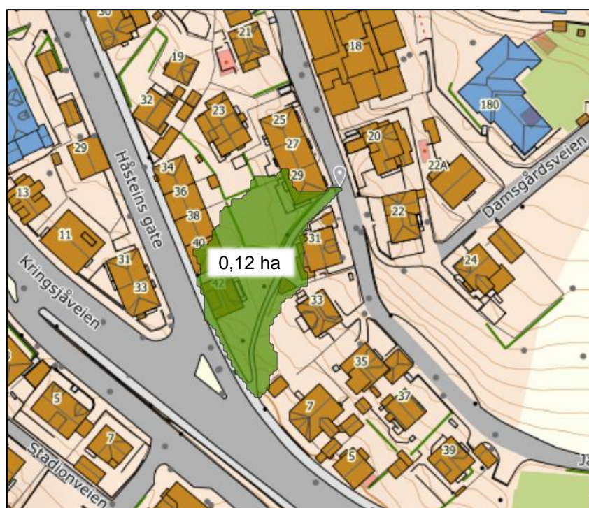
Figur 2, Kartutsnitt som viser beregnet nedbørsfelt for gangveg til Jansons gate. Modelleringen er gjort med Scalgo.
