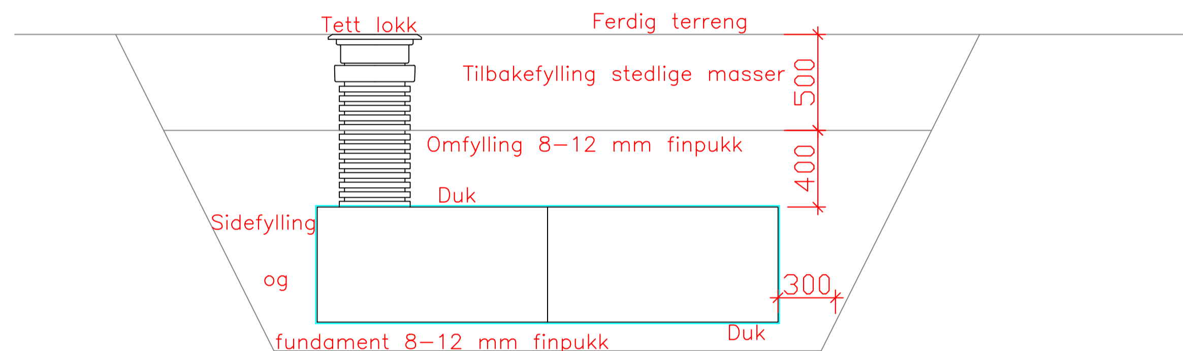
Snitt infiltrasjonsanlegg kassettsystem
