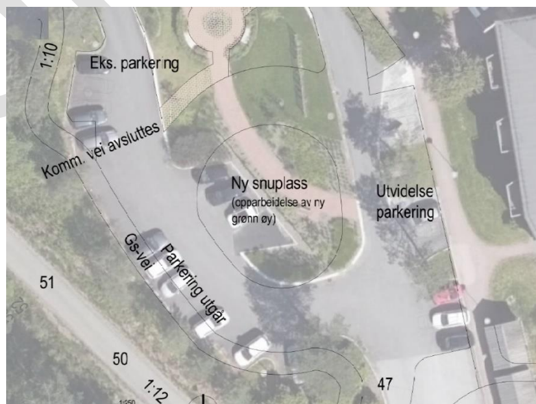
Figur 5-19: Alternativ med snuplass for kommunal vei i sørenden av eksisterende Frieda Fasmers minne sitt område
