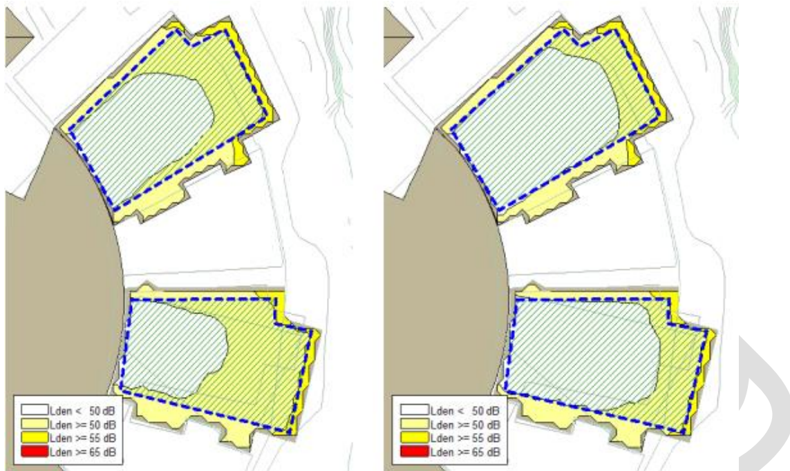
Figur 5-46: Lydnivå Lden (dB) beregnet 1,5 m over takterrasser, rekkverkshøyde 1,2 til venstre, 1,8 m til høyre
