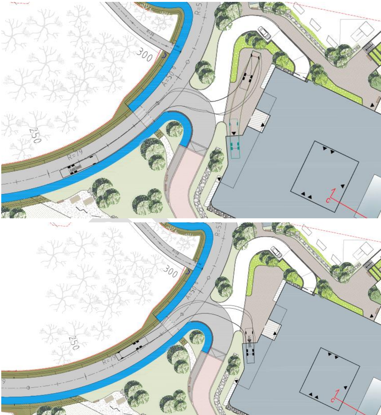
Figur 5-41: Varelevering og renovasjon, Nytt Frieda Fasmers Minne sykehjem. Innkjøring øverst, utkjøring nederst. Sporing for nødvendige kjøretøy for varelevering og renovasjon.
