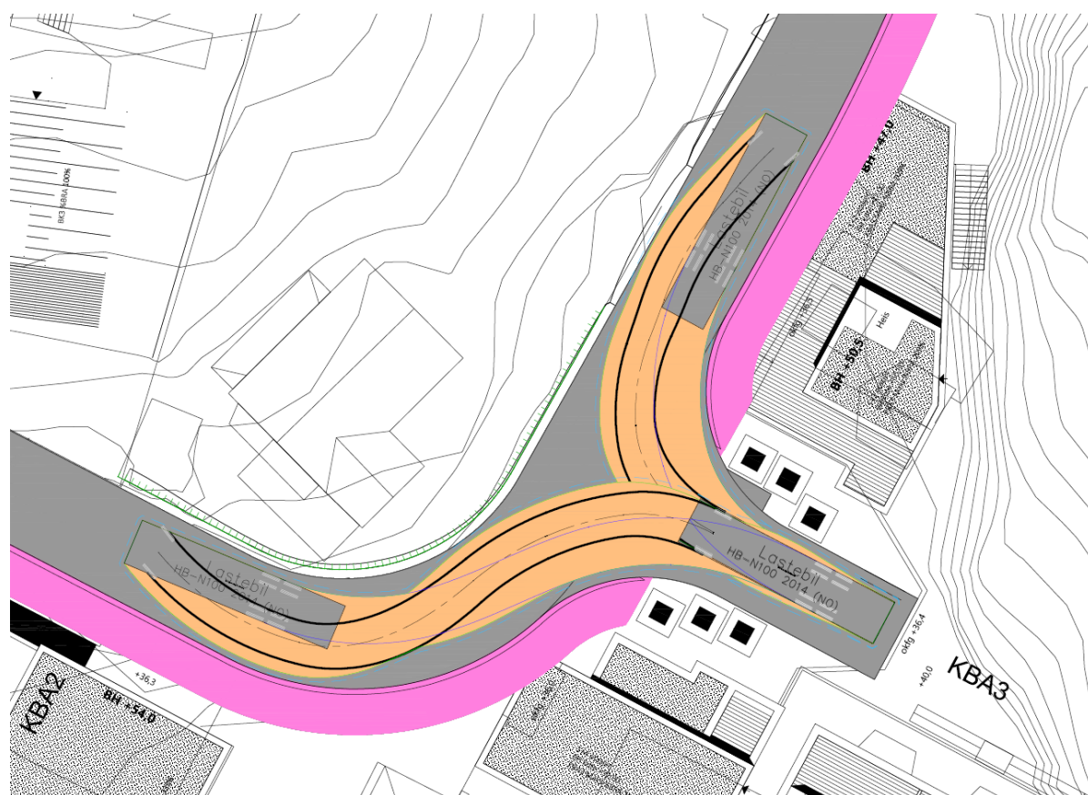
Figur 2-3 Sporningsanalyse med renovasjonsbil (sparing vist med en fart på 10 km/t, ytterste (røde) linje illustrerer en sikkerhetsmargin på 0,25m)
