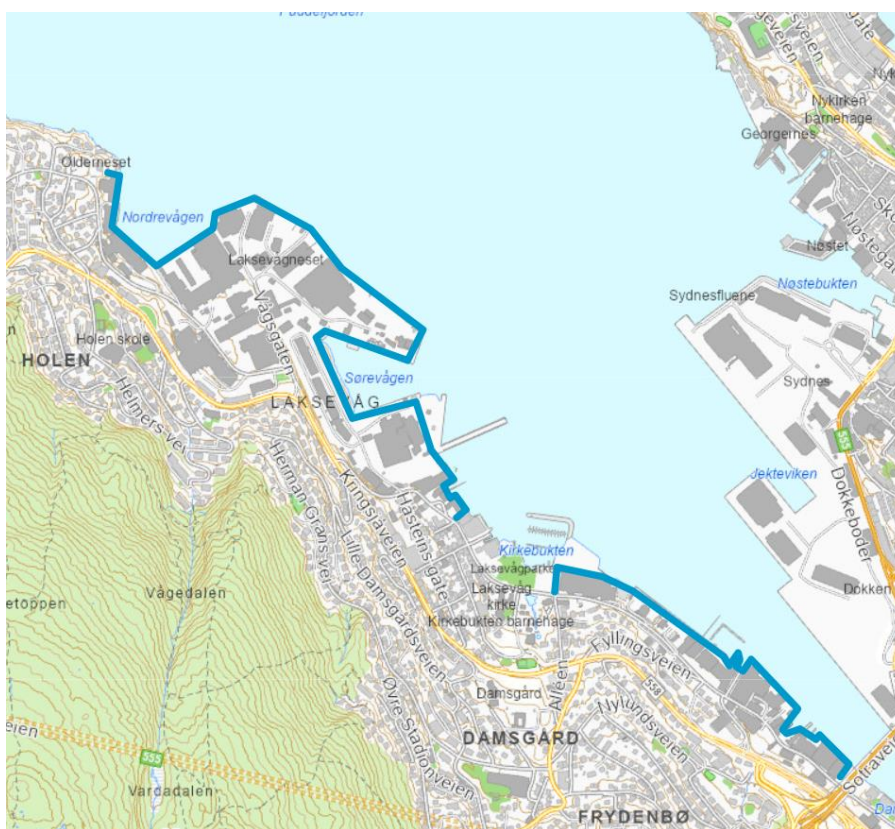
Figur 12-7: Behov for sikring med mobile flomvern/mur (uten fylling). Lengde er på ca. 3000m
