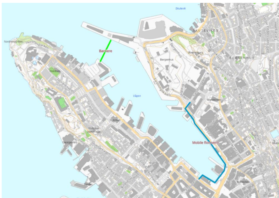
Figur 8-7 Behov for sikring av mobile flomvern/mur eller barriere (omtrentlig plassert). Totale lengde omtrent 700m
