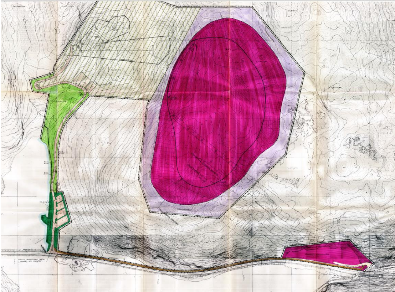
Figur 2-8 Opprinnelig reguleringsplan for steinbruddet (fra 1984). Mørk lilla er steinbrudd, lys lilla er isolasjonsbelte. Eksisterende fjellanlegg vises til høyre for uttaksområdet. Kilde: Arealplaner.no
