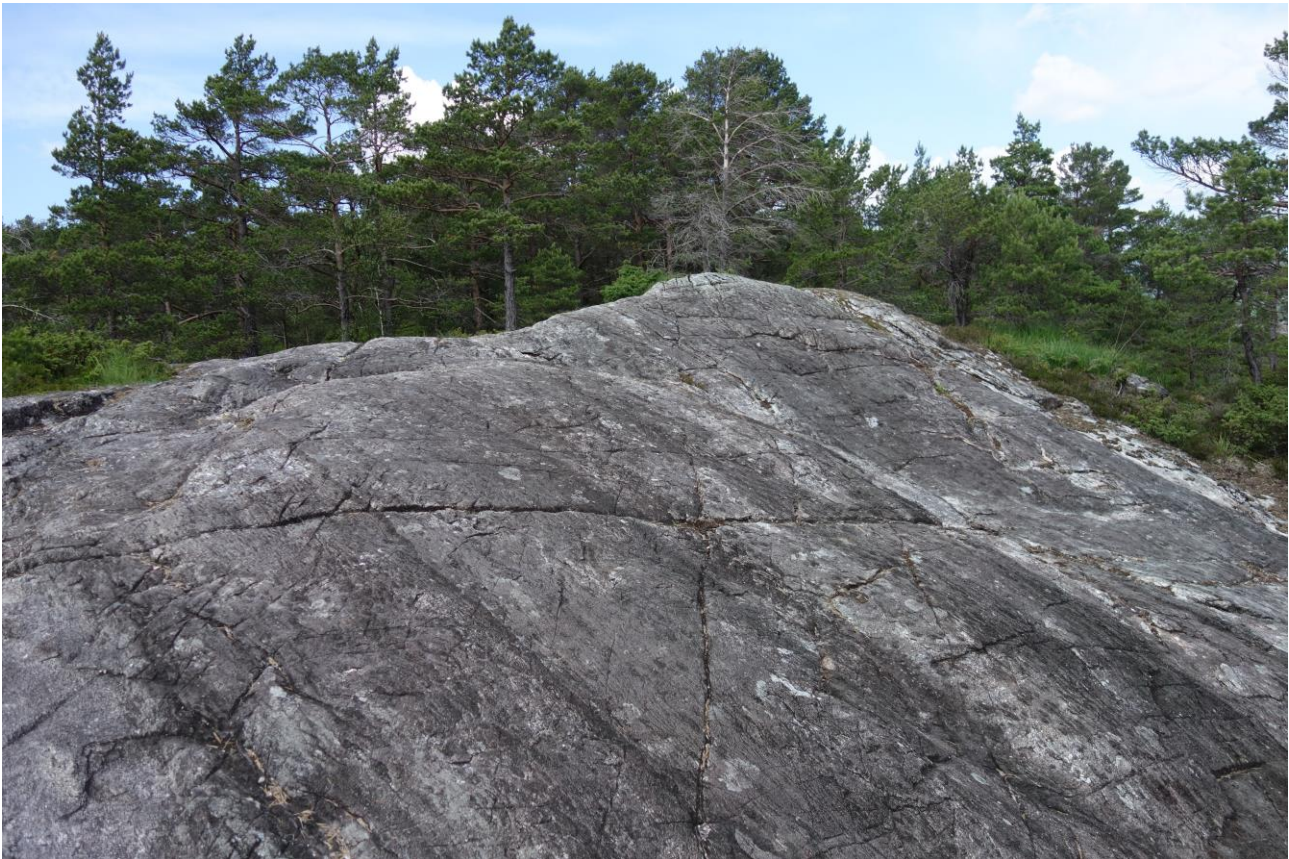
Figur 11. Oppsprekking i dagen med både gjennomsettende og mindre sprekker. Bildet er tatt på Liafjellet rett nordøst for steinknuseverket.
