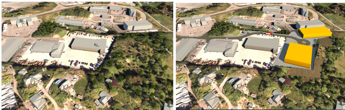
Figur 4: Bilde til venstre viser perspektiv av dagens situasjon. Bilde til høyre viser perspektiv med foreslått nye næringsbygg på felt I/L3 (markert med gule volumer), sammen med foreslåtte voller (brune hauger) med deponering av overskuddsmasser som skal gi skjerming mot naboer i eksisterende boligbebyggelse. Begge bilder er sett fra vest mot øst.
