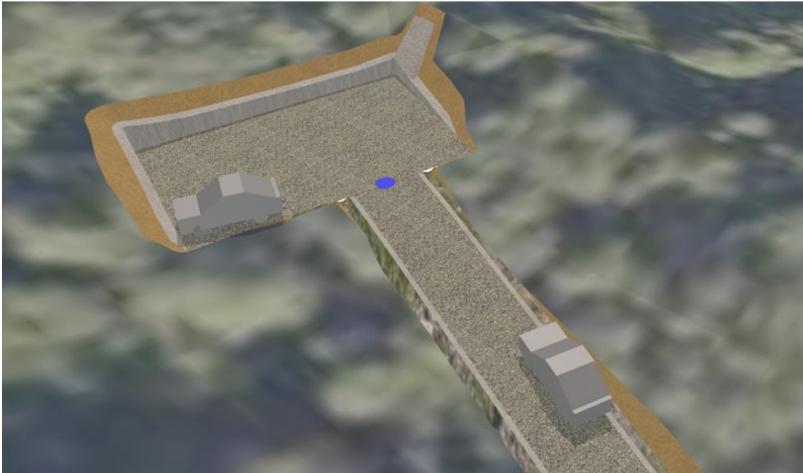
Figur 4: Det vil bli noen skjæringer i terrenget der vanntårn og oppstillingsplass etableres (o_VF).
