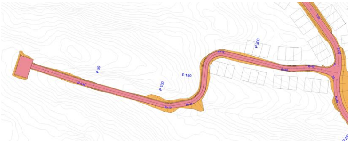
Figur 5: Illustrasjon over terrenginngrep (skjæringer og fyllinger) knyttet til vei og oppstillingsplass. Mindre justeringer som følge av endringer i formålsgrenser kan forekomme (regulert areal for vanntårn (o_VF) er noe større enn illustrasjon viser).
