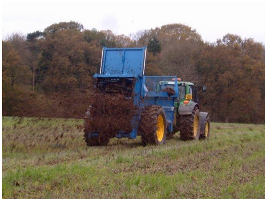
Tørrgjødselvogn uten canopy, ikke ideell for spredning av hestegjødsel på eng, men ok i åpenåker, og dersom gjødsla er godt omdanna og ensarta i konsistens.
