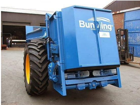
Tørrgjødselvogn med canopy og vinger nederst på stående valser, godt utstyr til spredning av hestegjødsel
