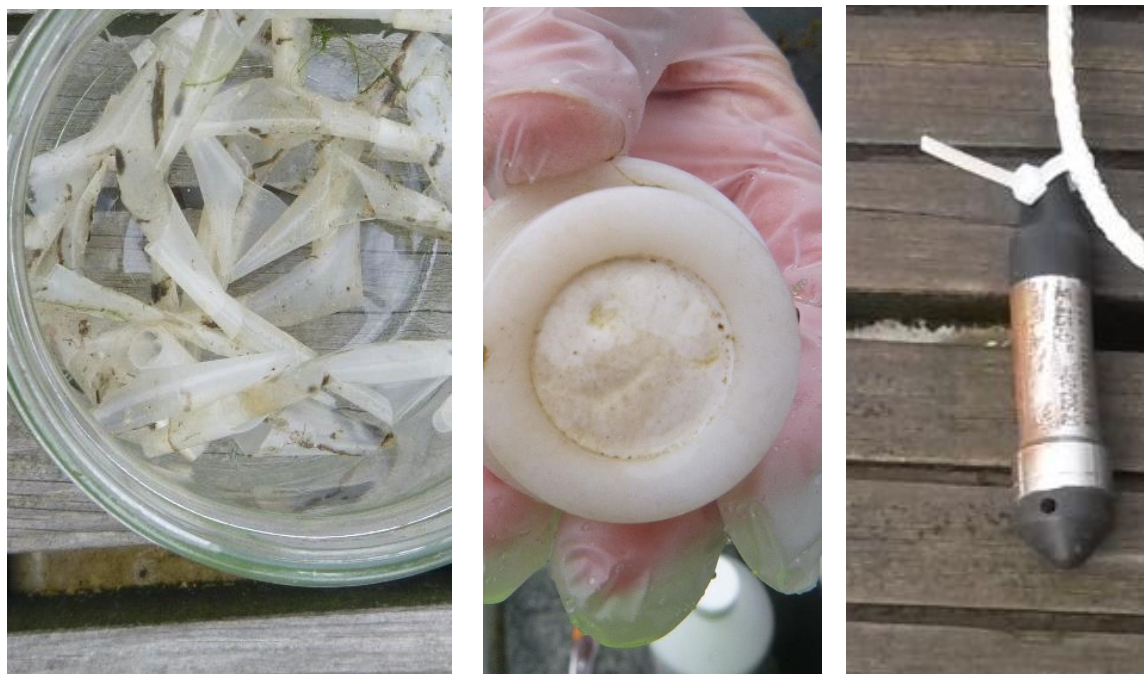
Figur 5 Passive prøvetakere, POM (venstre) DGT (midten) Diver for temperaturmåling (høyre)
