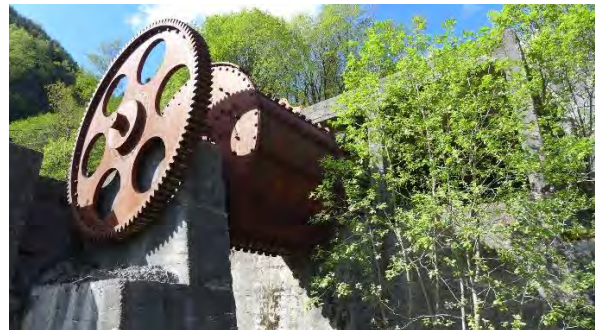
Figur 44: En av tromlene som stod for knusingen av kalken på veien nedover i anlegget (Foto: Byantikvaren, Bergen kommune 2019).
