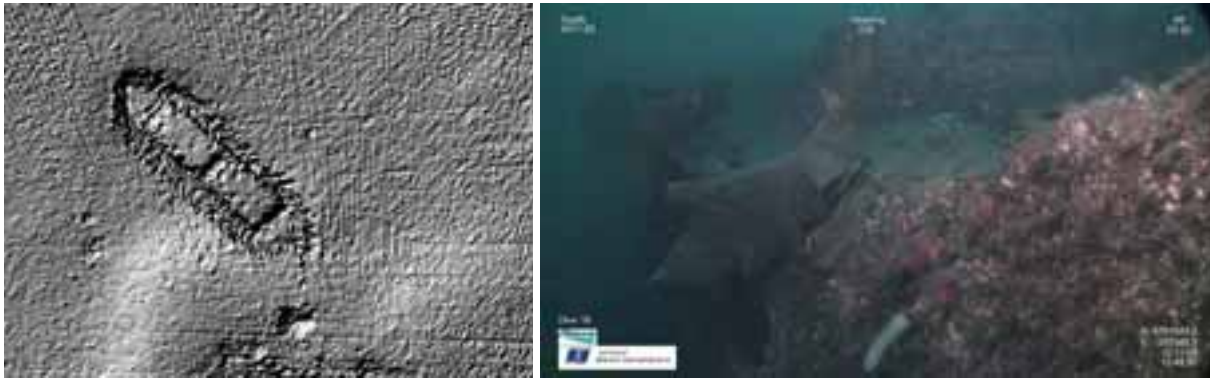
Figur 12 Vrak 1 vist med multistråleekkolodd til venstre. Til høyre ROV-bilde av vraket, fra styrbord side av baug. Vi ser gattet på skutesiden, og fremste del av karmen til lasterommet (Multistråle og ROV-film: Argus Survey)
